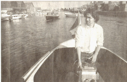
Anton van Wijk demonstreert de ElektroSloop, een sloep die elektrisch wordt voortgedreven. "Met de accu in deze sloep kun je zeker tien uur varen." (Foto: Pier van der Heide).
